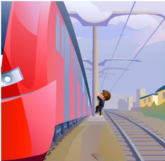
Напряжение в проводах железной дороги — 27 000 Вольт. Получить такой удар — все равно что засунуть вилки в 122 розетки одновременно. Приближаться к контактной сети железной дороги на расстояние ближе 2-х метров опасно для жизни.
